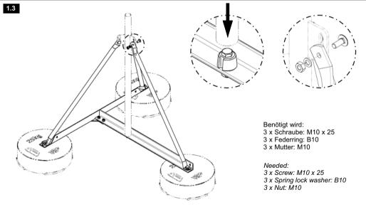
1.3: - Mast auf Fixierung stecken und Sicherungsstreben ausrichten und an Fangmast montieren. Anschließend alle Schrauben fest ziehen.
